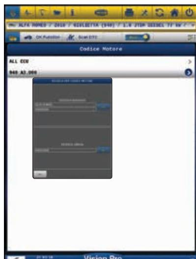
Funkcija vam omogućuje da brzo i jednostavno odaberete vozilo. Omogućuje precizno odabiranje određenog vozila opremljenog, na primjer, određenim vrstama kontrolera upravljanja.
