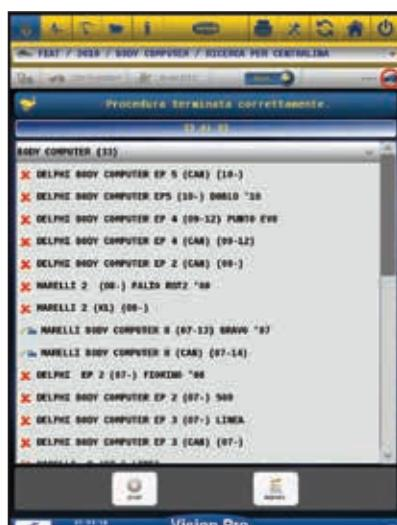
Softver automatski identificira i prepozna kontroler upravljanja, koji se može montirati u vozilo kako bi izbjegli problem s prikazom parametara ili grešaka. Skeniranje se temelji na dva kriterija pretraživanja: jednom robnom markom i sličnim robnim markama.
