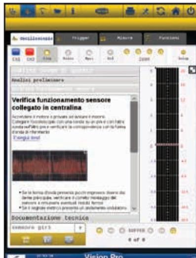
Korisni vodič koji se odnosi na rukovanje osciloskopom s funkcijom prethodne selekcije mjerne skale i srodnih grafikona vezanih uz ispitivanje električnih komponenti vozila, kao što su senzori, aktuatori itd.
